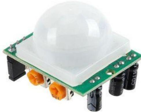
Figura 8: Sensore di movimento
