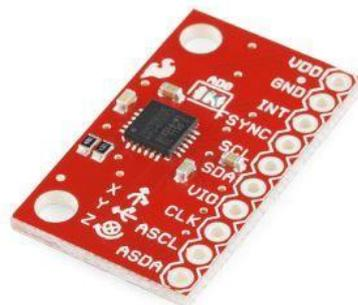
Figura 10: Sensore breakout con accelerometro e giroscopio a tre assi
