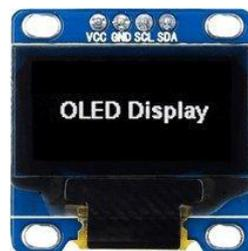
Ein OLED-Display funktioniert ohne Hintergrundbeleuchtung. Deshalb hat das Display einen so hohen Kontrast, einen extrem weiten Betrachtungswinkel und kann tiefe Schwarzwerte anzeigen. Durch das Fehlen der Hintergrundbeleuchtung wird der für den Betrieb des OLED-Displays erforderliche Strom erheblich reduziert.
