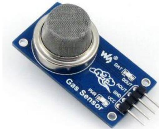
Abbildung 11: Gassensor
