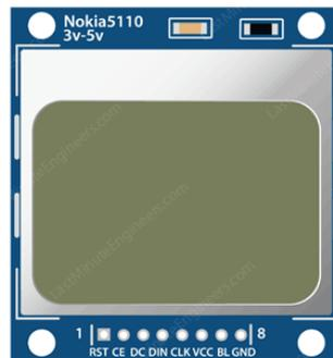
Es handelt sich um Grafikdisplays mit 84×48 Pixeln. Sie werden über eine serielle Busschnittstelle, ähnlich wie SPI, an Mikrocontroller angeschlossen. Das LCD verfügt auch über eine Hintergrundbeleuchtung in verschiedenen Farben wie Rot, Grün, Blau und Weiß. Bei der Hintergrundbeleuchtung handelt es sich um vier LEDs, die an den Rändern des Displays angebracht sind.
