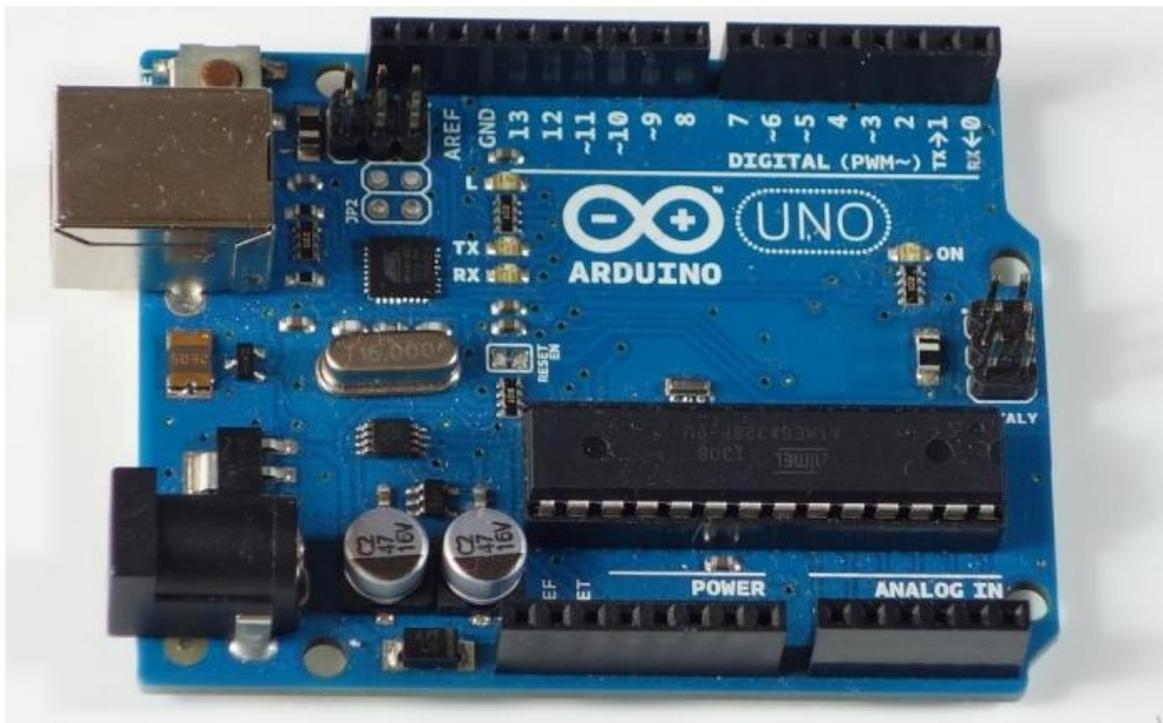
Im Grunde handelt es sich um eine kleine Entwicklungsplatine mit einem Gehirn (auch Mikrocontroller genannt), welche man an elektrische Schaltungen anschließen kann. Das macht es einfach, Eingänge zu lesen, Daten von außen zu lesen, Ausgänge zu steuern oder einen Befehl
