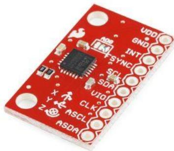
Abbildung 9: Dreiachsen-Beschleunigungsmesser und Gyro-Breakout-Sensor
